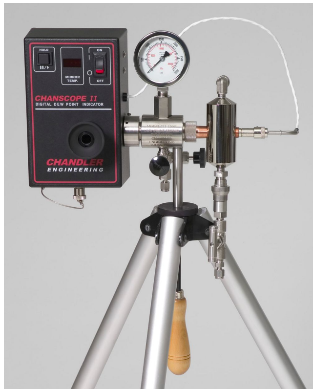
Анализатор Chanscope II
