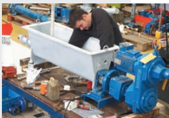
Модернизация насоса Муано серии GBB с установкой нового устройства сводообрушителя
